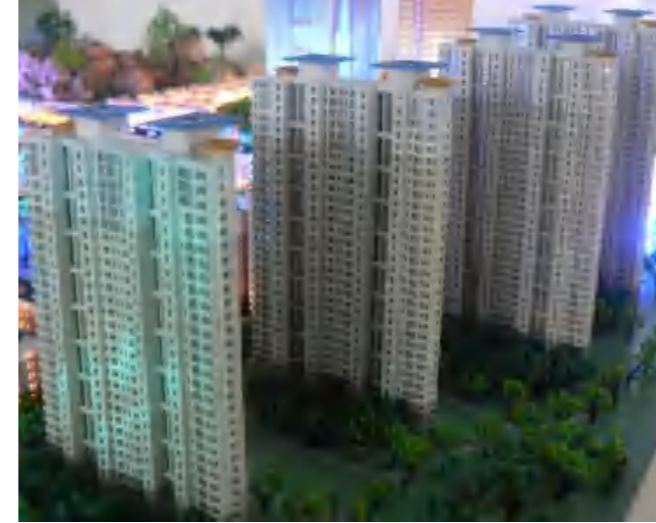
城市城市建筑： 由于大多在城市阶段，采用素色亚克力材料，以和现状及有方案的建筑进行区分。
